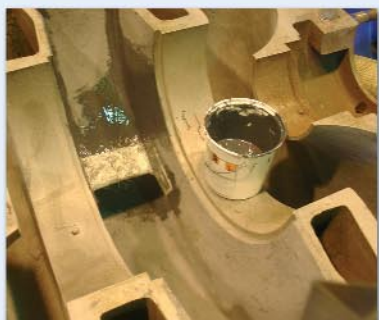
3. kép: Loctite® 7227 alkalmazása a szivattyúházon és a belépő éleknél
